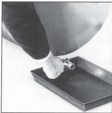
Abb. 6.3: Kondensat manuell ablassen
