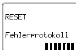
Die Blöcke in der letzten Zeile verschwinden nacheinander. Erst wenn der letzte Block verschwunden ist, wird der Reset der Wartungsmeldung durchgeführt. Wenn Sie die Taste loslassen, bevor alle Blöcke verschwunden sind, wird der Reset abgebrochen. Nach Durchführen des Resets kehrt die Displayanzeige automatisch zur übergeordneten Ebene zurück.
