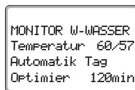
Der berechnete Sollwert und der gemessene Wert für die **Warmwassertemperatur** werden angezeigt.
